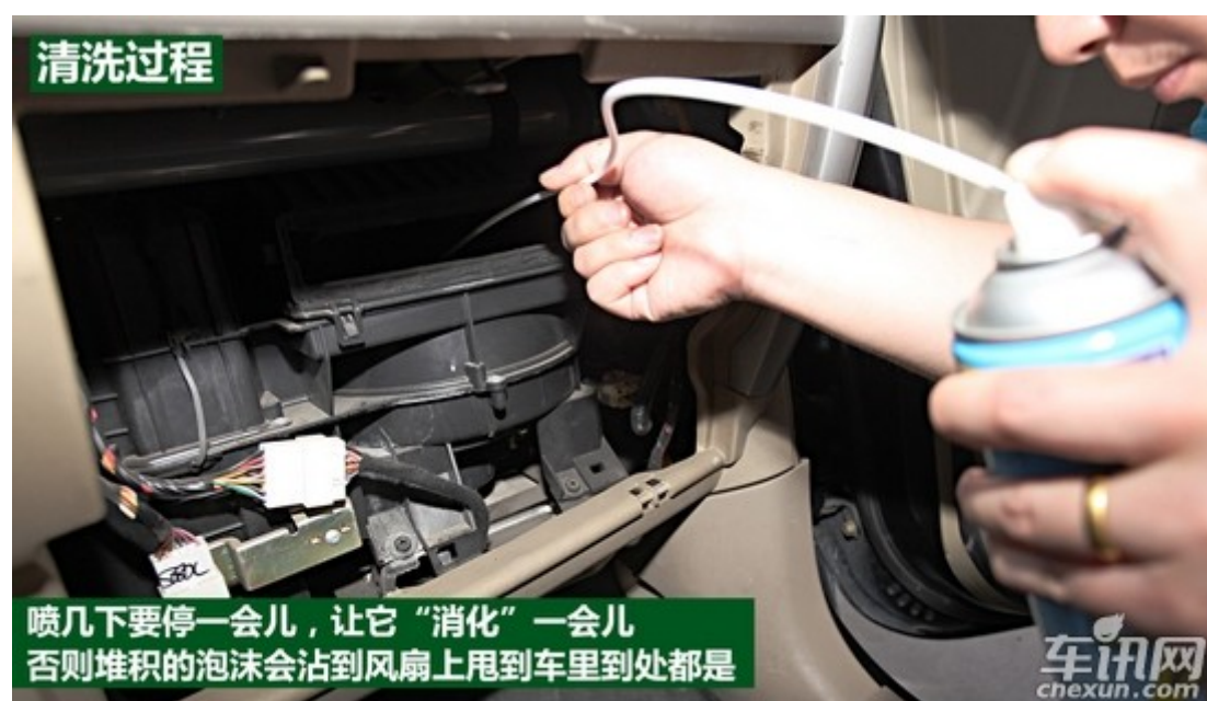
汽车空调 DIY 清洗体验
