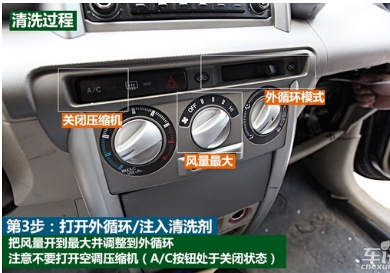
汽车空调 DIY 清洗体验
