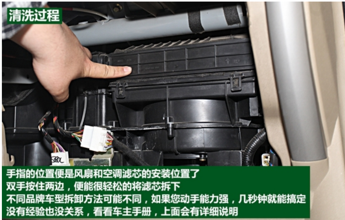
汽车空调 DIY 清洗体验
