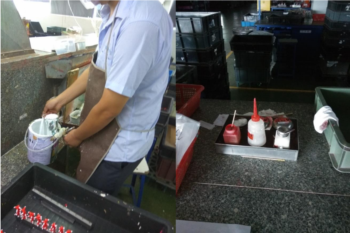
（工人在没有保护直接接触化学用品）
