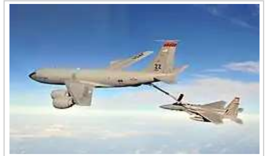
部屬於嘉手納空軍基地的美國空軍第18聯隊 KC-135R空中加油機正在為第67戰鬥機中隊的F-15C戰鬥機執行空中加油
