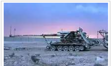
朝鮮以59式坦克改裝的170毫米谷山M-1978自走砲。
